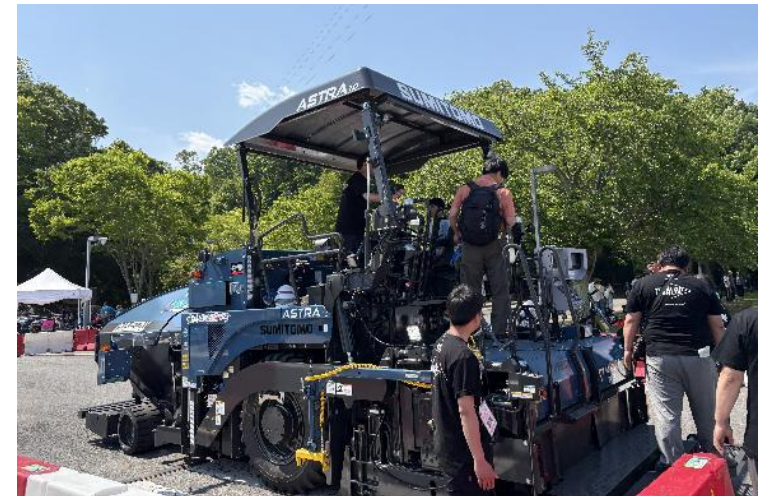
「アスファルトフィニッシャー」デモンストレーション
