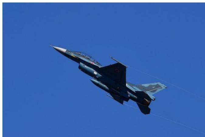
F-2Bは、米国のF-16を、日本の運用の考え方や地理的な特性に合わせ、日米の優れた技術を結集し日米共同で改造開発した戦闘機です。昭和63年にFS-Xとして開発に着手し、平成7年に初飛行、12年度に開発は完了いたしました。F-16からの主な改造点は、旋回性能の向上のため主翼面積を増やし、軽量化のため先進材料や先進構造を取り入れたこと。また離陸性を高めるためエンジンを推力向上型に変え、さらに最新レーダーなど、先進の電子機器を採用しています。
