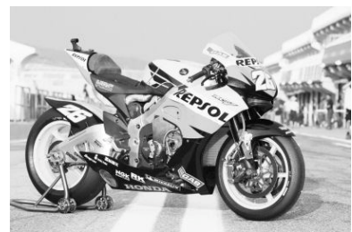
Honda RC212V (800cc 4ストロークV型4気筒エンジン搭載)
